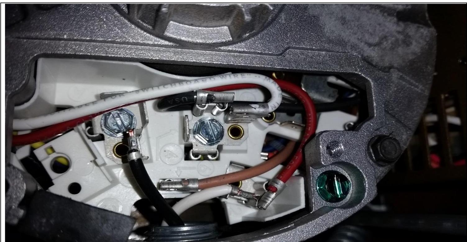
Схема подключения 110 В
