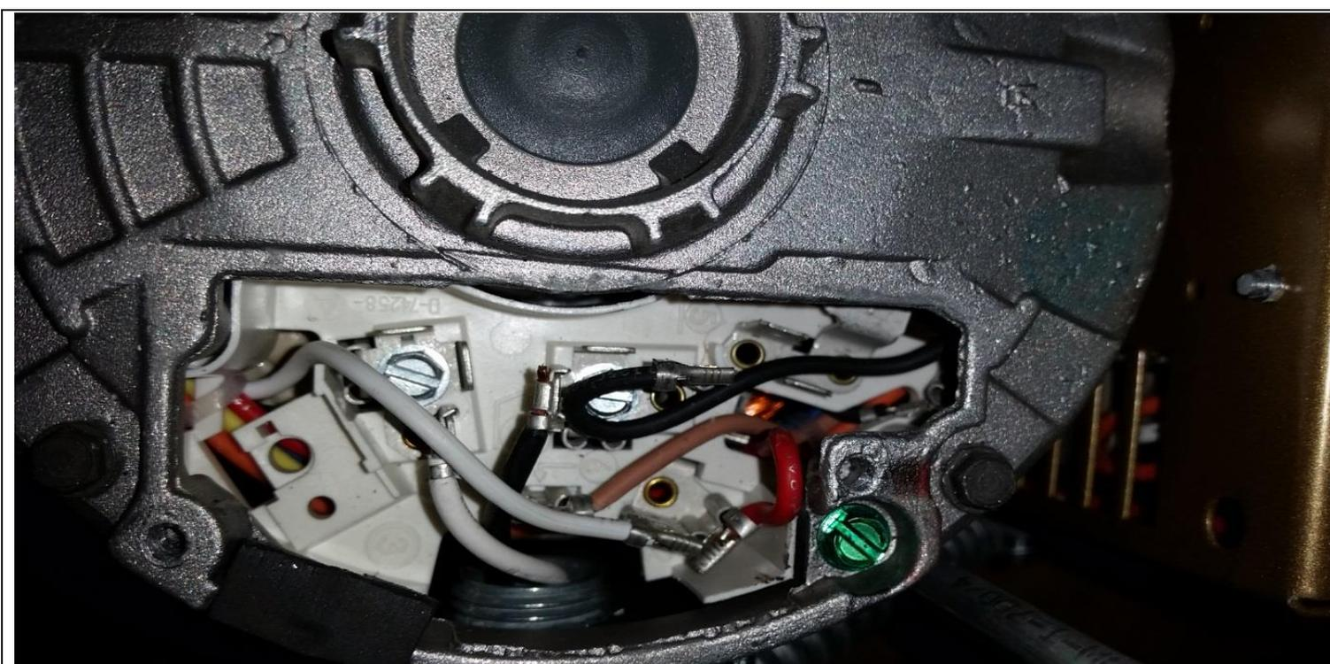
Схема подключения 220 В
